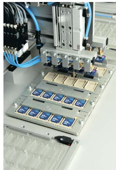
Speicherkarten-Transport durch Unterdruck
