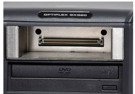
Das Kopiermodul aus Edelstahl in Kombination mit einer Edelstahlrückwand der CardBoxen verhindert elektrostatische Entladungen
